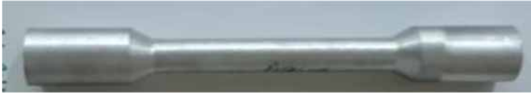
Fig. 2. Tensile test specimen.
